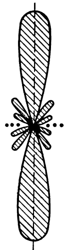
Рис. 4.7. Пространственная диаграмма направленности антенной решетки
